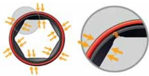
Auch bei Rissbildung der Stecknuss ist die Einsatzfähigkeit gewährleistet
