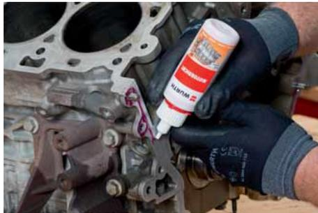
**Ersatz für Feststoffdichtungen rund um den Motor, an Druckkesseln sowie an Schraubverbindungen.**
