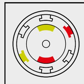
Längere Lebensdauer des EC-Motors, wartungsarm, da kein Kohlebürstenwechsel gemacht werden muss. Effizienterer und leistungsstärkerer Motor bei geringerer Baugröße.
