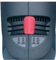
Rechts-Links-Umschalter an der Gehäuseoberseite sorgt durch optimale Stellung der Kohlebürsten für maximales Drehmoment in beiden Drehrichtungen und verlängert die Lebensdauer der Kohlen erheblich.
