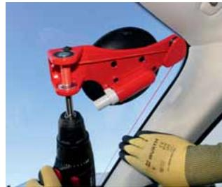
**9-teilig. Zum einfachen und kostengünstigen Austrennen von geklebten Kfz Front- und Heckscheiben.**
