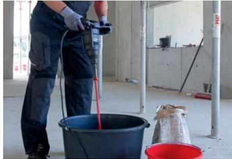
**Das 1.010 Watt starke und kompakte Rührwerk ist mit dem passenden Rührkorb für vielfältige Mischaufgaben bis max. 40 Liter Mischvolumen bestens geeignet.**
