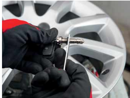
Dichtung andrücken mit der Ringseite
