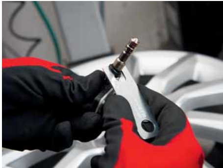
Dichtung abziehen mit der offenen Gabelseite
