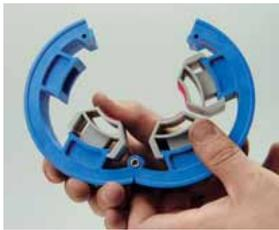
Zum Rohrdurchmesser passende Schleifmanschette und Schleifsegmente auswählen.
