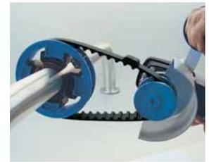
Zahnriemen um Zahnscheibe der Antriebsmaschine legen, Drehzahl einstellen (**max. 2.000 U/min.**), Zahnriemen auf Zug halten.
