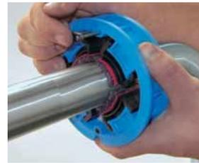
Schleifmaschette mit Sicherungsstift verschließen und mit gelbem Bügel sichern.
