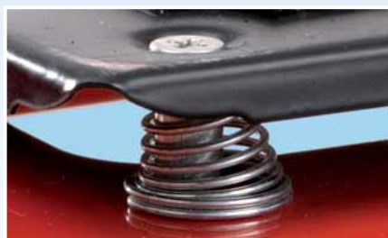
Gefederte Grundplatte verhindert das Splintern der Fliese beim Brechen
