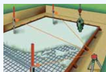
Nivellierarbeiten von Decken- und Bodenplatten
