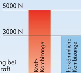
Schneidleistung bei 400 N Handkraft
