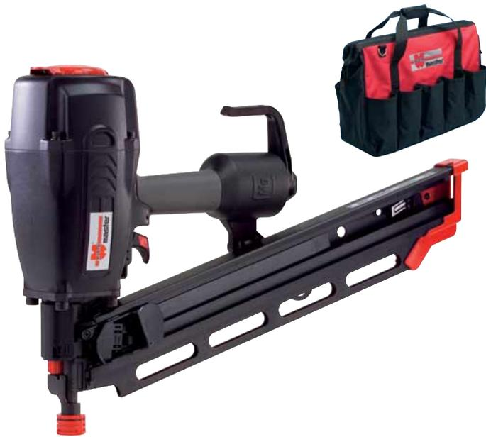
**Kraftvoller Druckluftnagler zur Verarbeitung von Rundkopf-Streifennägeln mit 21–22°-Neigung, in den Durchmessern 2,9–4,1 mm, Länge 50–90 mm. Anwendungsbereiche sind unter anderem Fertighausbau, Innenausbau, Zimmereien, Paletten, Unterkonstruktionen und Fußböden.**
