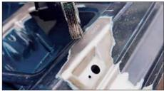
Art.-Nr. 0703 350 31 VE/St. 5 Einsatzbereich: Entlacken in Konturen- und scharfkantigen Bereichen 90° Winkel. Kein Sandstrahleffekt.
