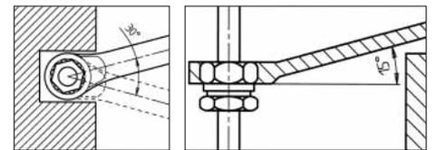
Der um 15° abgewinkelte Schaft ermöglicht bessere Zugangsmöglichkeiten
