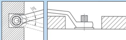
Durch die gekröpften Ringköpfe und den Ratschenmechanismus können Verschraubungen an tiefliegenden Schrauben optimal gelöst werden.
