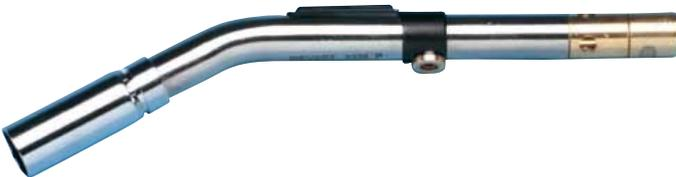
Spezialbrenner – der Gasstrom wird durch schräggestellte Kanäle aufgeteilt und durch das Stahlbrennerrohr zu einer Zyklonflamme geformt. Die Wirbelflamme umhüllt das ganze Rohr und bewirkt eine gleichmäßige Temperatur auch auf der Rückseite. Die leistungsstarke Flamme eignet sich hervorragend für eine Vielzahl von Wärmearbeiten.
