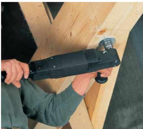
Selbst Schraubverbindungen bei Balken sind aufgrund des hohen Drehmoments kein Problem.
