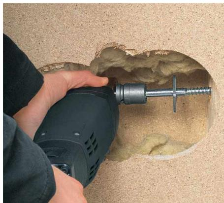
Arbeiten bei unzugänglichen Stellen können mit abmontierten Zusatzhandgriff durchgeführt werden.
