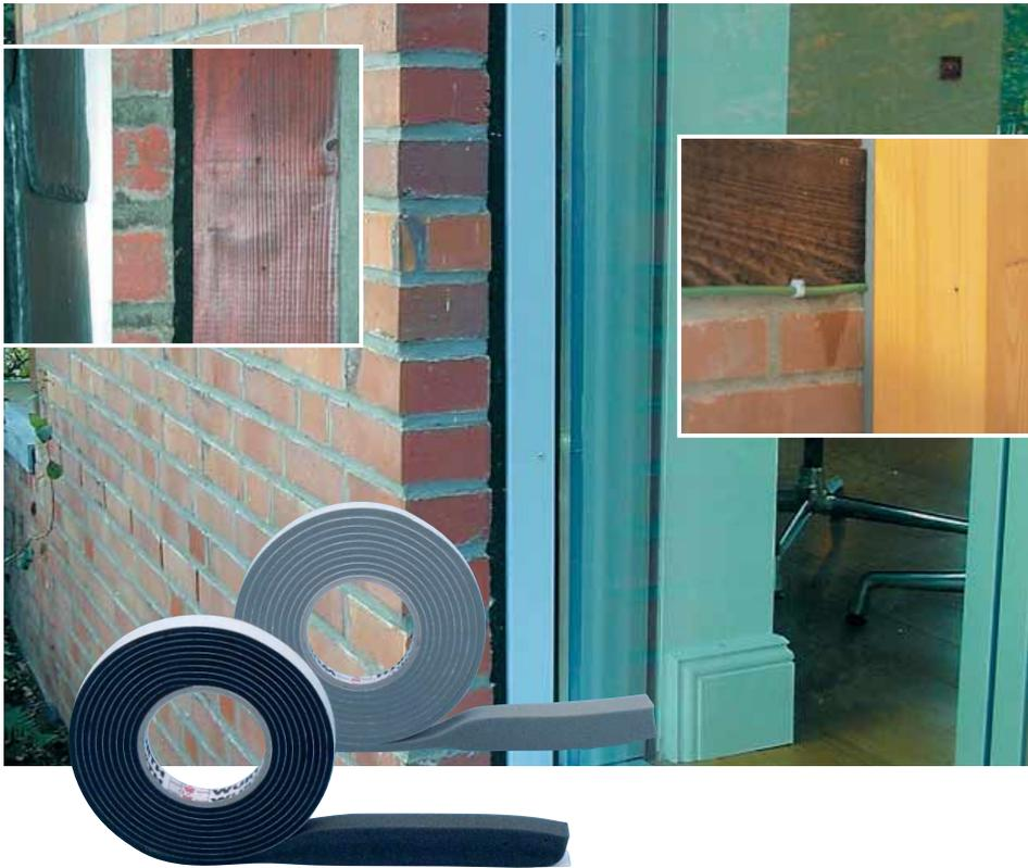
**Hochwertiges imprägniertes, vor-komprimiertes BG2-Dichtungsband mit geprüfter Schlagregendichtigkeit bis 300 Pascal.**
