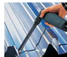
Mit der Verlängerung können Bleche mit einer Sickentiefe von bis zu 160 mm durchtrennt werden.
