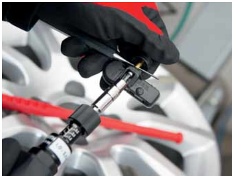
Fixierung Gummiventil am Reifendruck- Kontrollsensor mit 1,4 Nm Art.-Nr. 0714 71 91
