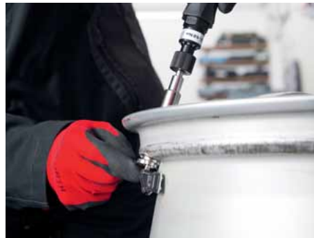
Anziehen der Überwurfmutter des Reifendruck- Kontrollensors mit 8,0 Nm Art.-Nr. 0714 71 92
